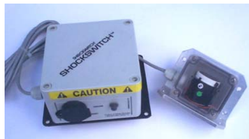
Boîtier SC1060 avec capteur de choc déporté
