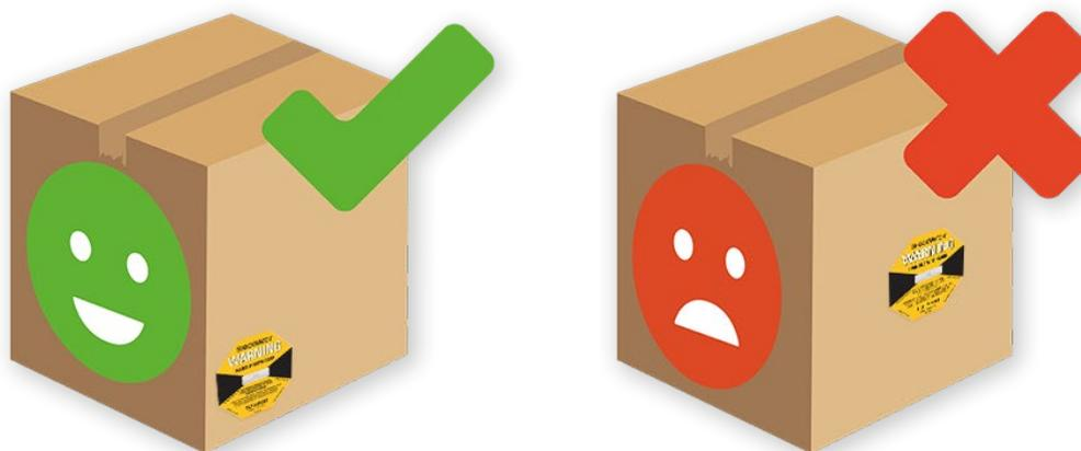
**Explications** : Si le ShockWatch est collé sur une partie souple du colis (par exemple au centre d'un emballage carton), il se déclenchera plus tardivement puisque la partie souple de l'emballage va amortir l'intensité du choc.
