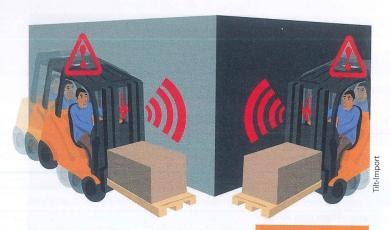
La solution Hit Not retenue par Imperator permet d'éviter les collisions entre des engins en mouvement ou entre un engin et un pieton.
