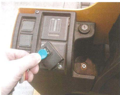
■ Le contrôleur de choc Shockswitch Impact Manager se présente sous la forme d'un boîtier pouvant être monté sur tout engin de manutention (doc. TILT IMPORT).
