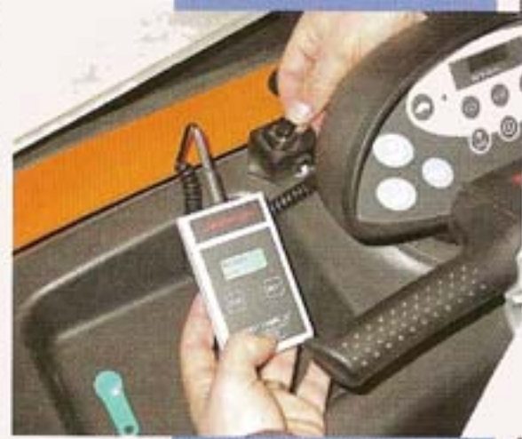
Le boîtier de prélèvement des données sur la machine
